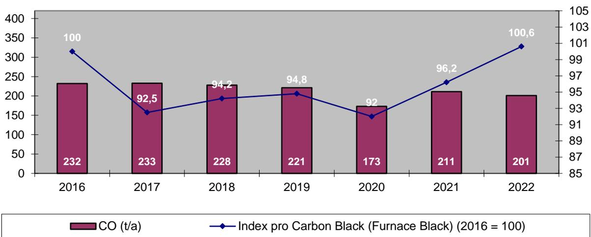
Abb. 2.18: C-Gesamt-Emissionen im Furnace Black-Verfahren (t/a)
