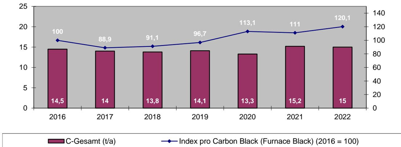
Abb. 2.19: CO<sub>2</sub>-Emissionen im Furnace Black-Verfahren (t/a)
